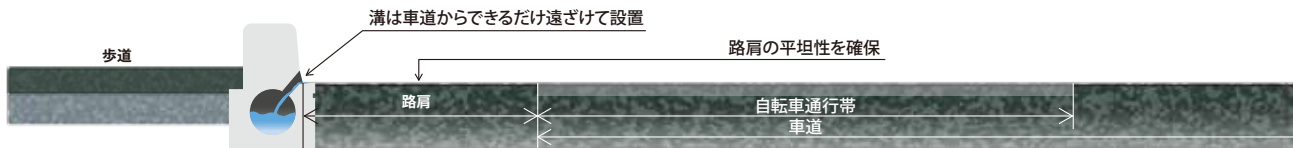
図2-21 路肩と排水施設 路肩での自転車の走行性を高める工夫の例
