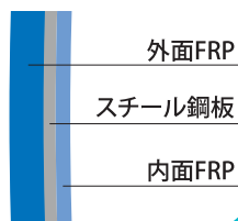
耐震性貯水槽 断面図
