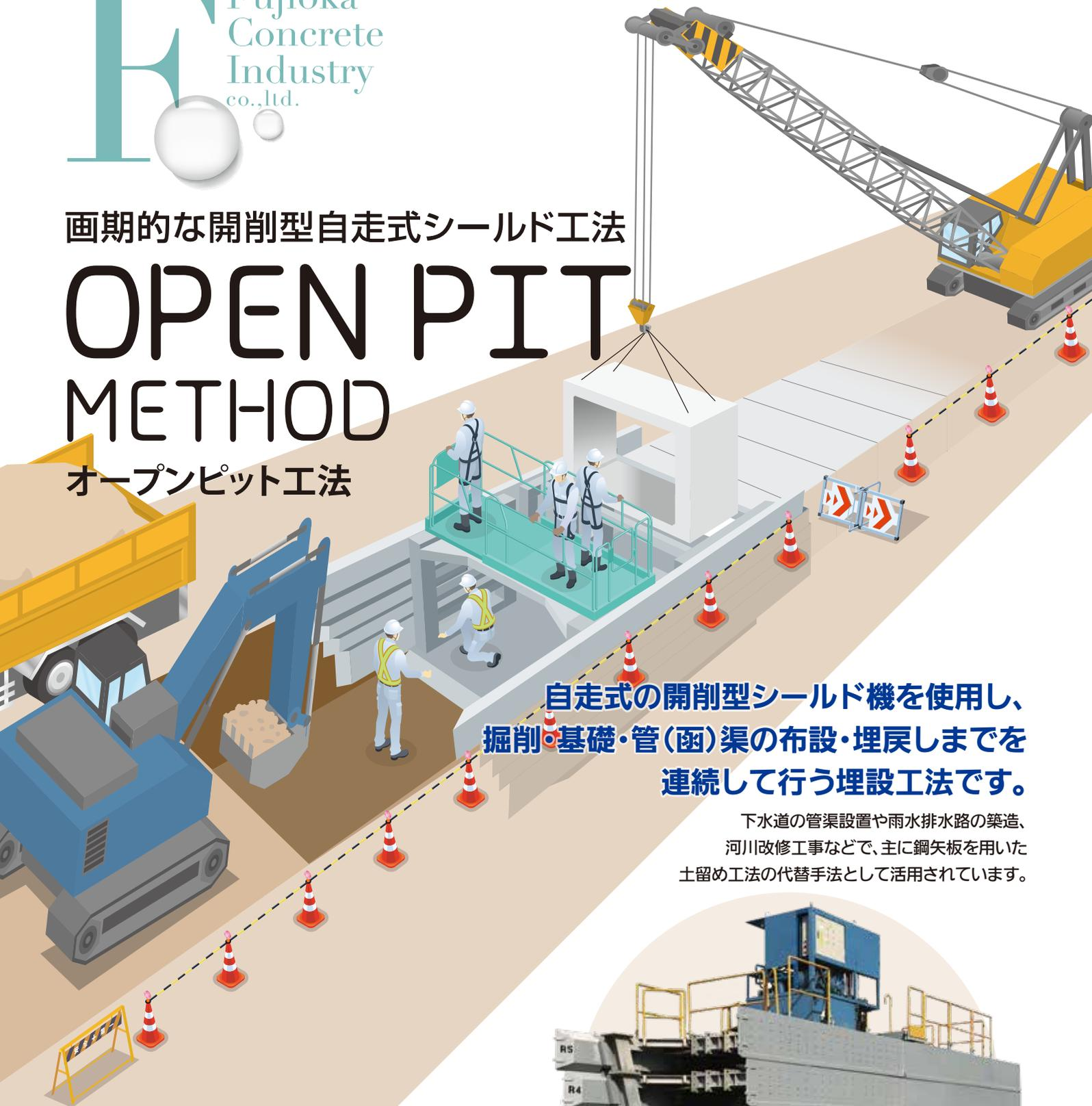
自走式の開削型シールド機を使用し、
