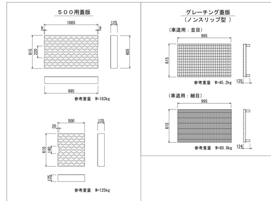
ハイブリッド型自由勾配側溝（縦断用）HB-FS500 断面図
